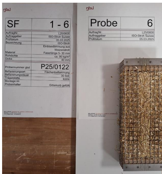
Vor dem Brandversuch / Before the fire test
