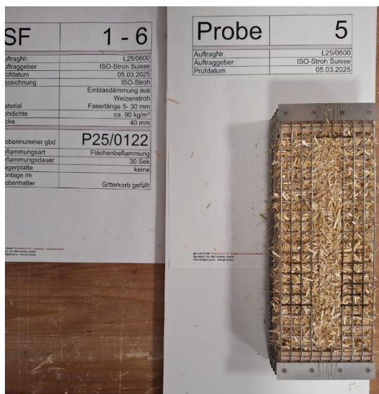
Vor dem Brandversuch / Before the fire test
