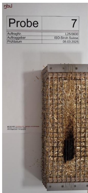
Nach dem Brandversuch / After the fire test
