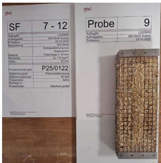
Vor dem Brandversuch / Before the fire test
