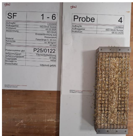
Vor dem Brandversuch / Before the fire test
