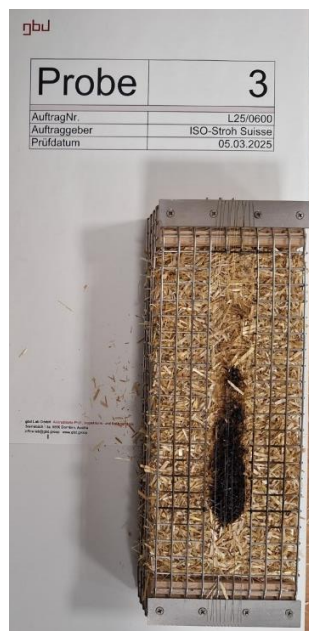
Nach dem Brandversuch / After the fire test
