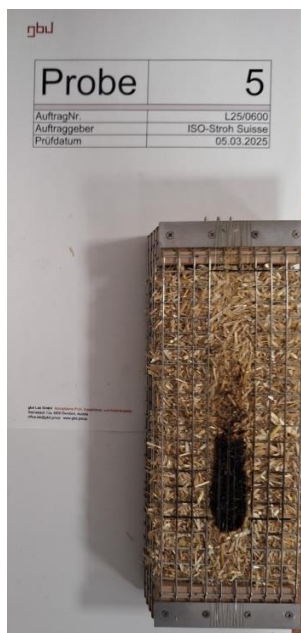
Nach dem Brandversuch / After the fire test
