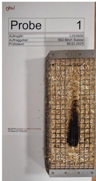
Nach dem Brandversuch / After the fire test
