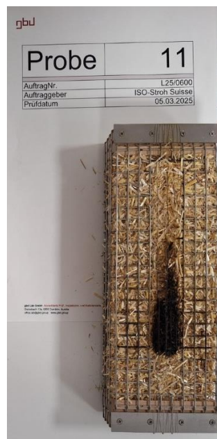
Nach dem Brandversuch / After the fire test
