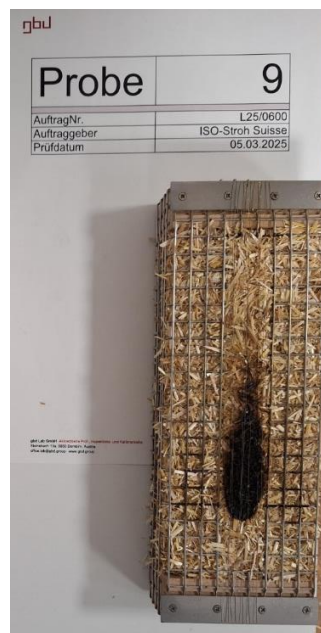
Nach dem Brandversuch / After the fire test
