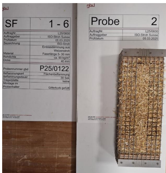
Vor dem Brandversuch / Before the fire test
