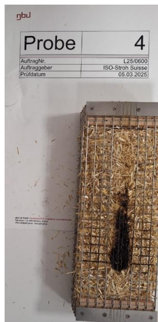
Nach dem Brandversuch / After the fire test
