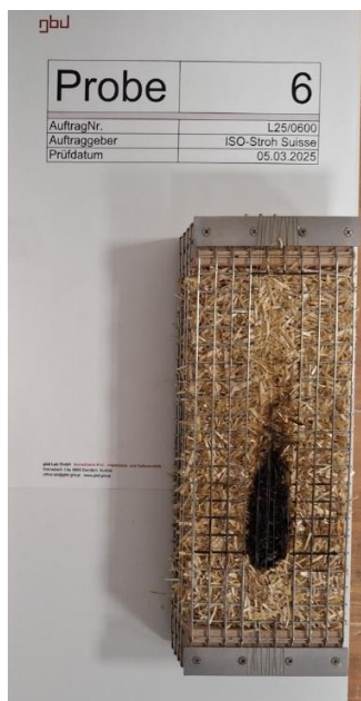
Nach dem Brandversuch / After the fire test
