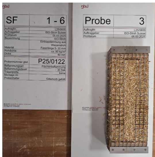
Vor dem Brandversuch / Before the fire test
