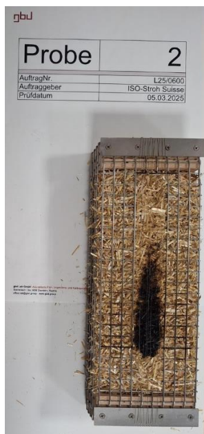
Nach dem Brandversuch / After the fire test
