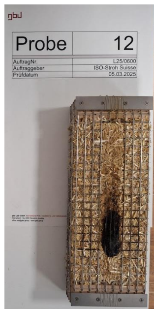
Nach dem Brandversuch / After the fire test
